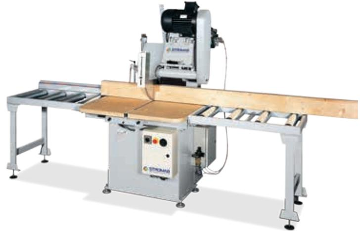
Mit festem oder schwenkbarem Sägeaggregat, manuell
